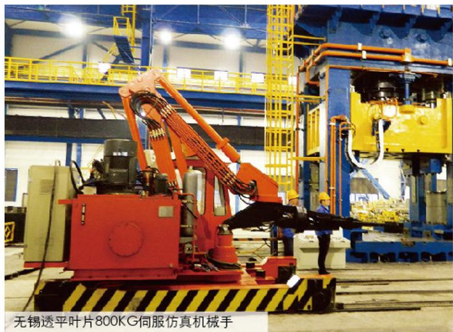
无锡透平叶片800KG伺服仿真机械手
