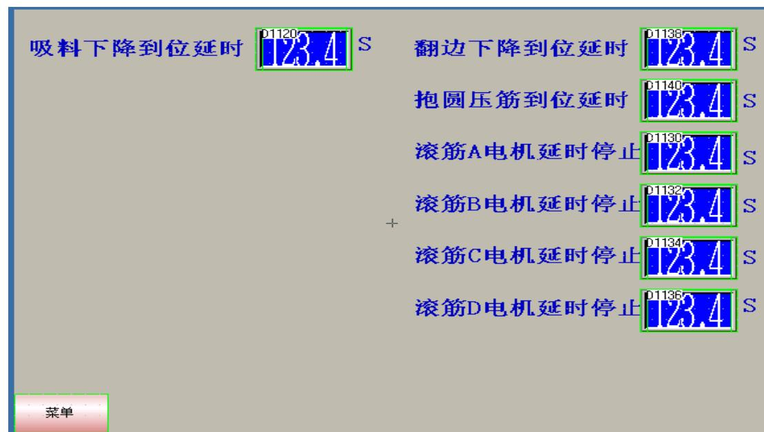
此界面为设备延时画面：包括上料吸盘吸料下降到位延时，翻边下降到位延时，抱圆压筋到位延时，滚筋 A,B,C,D 电机延时停止，
