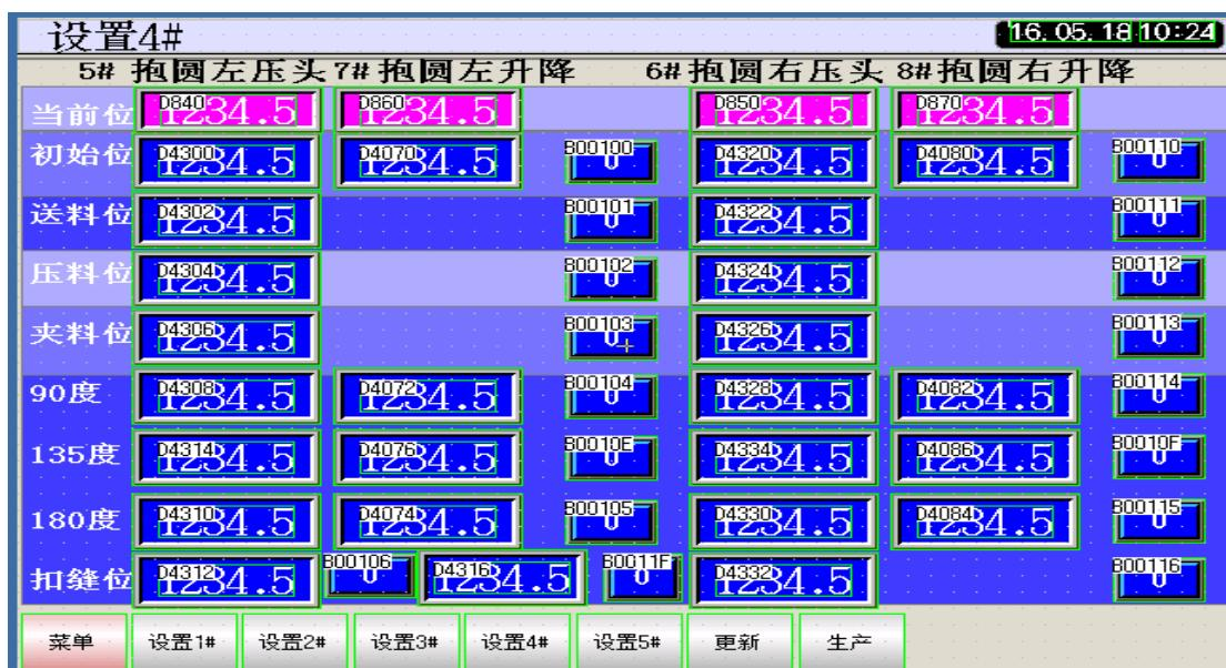
本界面为抱圆压头抱圆升降工作的位置包括：初始位，送料位，压料位，夹料位，90 度，135 度，180 度，扣缝位。输入相应的数据后保存到配方中以便调取使用。
