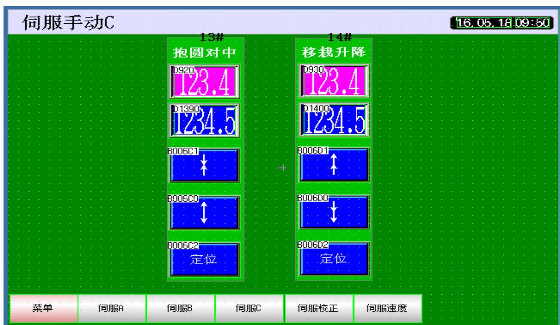
此界面上有设备各个伺服电机的操作键，点击相应的键即可对伺服进行相应的动作控制。
