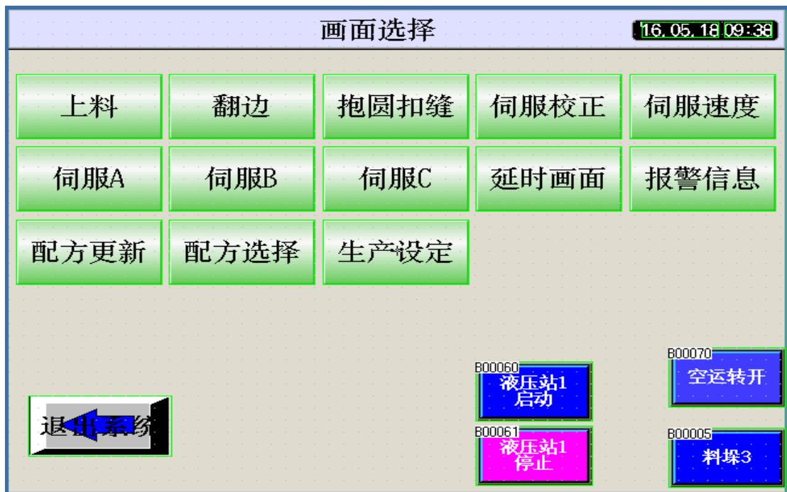
画面选择中包括了，手动上料，翻边工位，抱圆扣缝工位，伺服校正，伺服速度，配方更新，配方选择，生产设定，延时画面，报警信息。单击液压站启动，液压站停止。空运转开。
