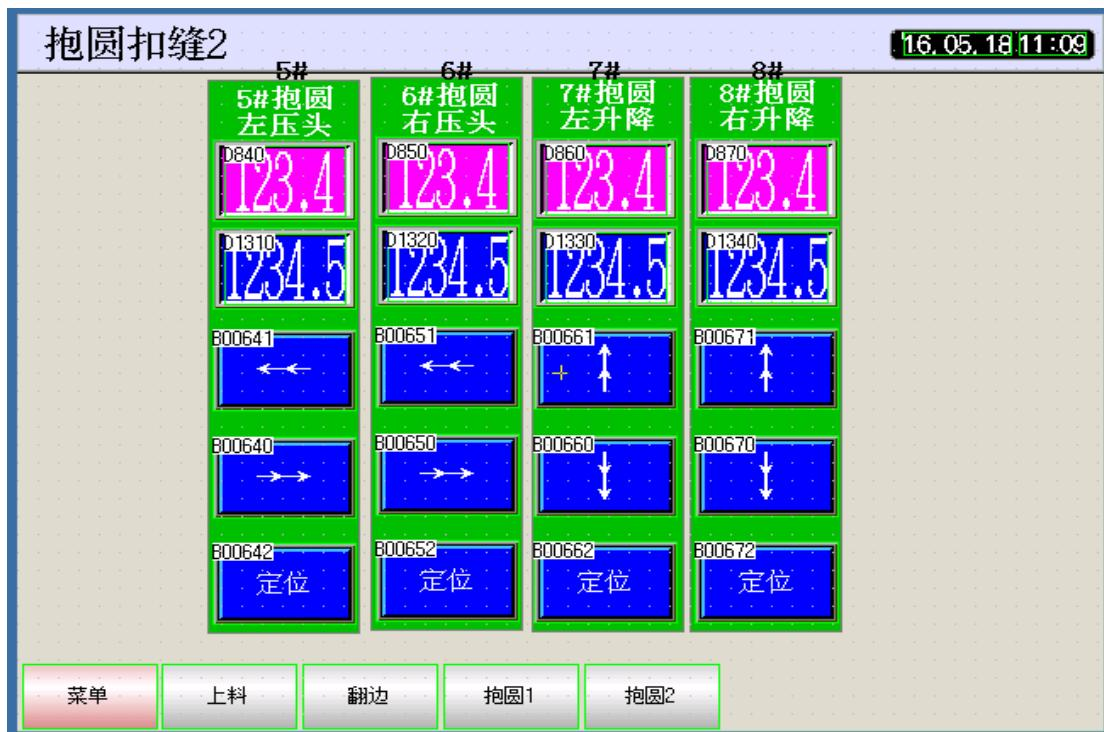
此界面为手动抱扣缝1,2操作画面。包括扣费压头上升下降，抱圆滚杠升降，侧定位缸进退，左右旋转夹紧缸进退，左右侧定位缸进退，左右翻转缸升降，工件顶出缸进退，抱圆电动滚筒，预涂胶电动滚筒，预涂胶压紧气缸手动按钮。另外包括：圈圆左，右调宽，抱圆对中手动，手动定位。
